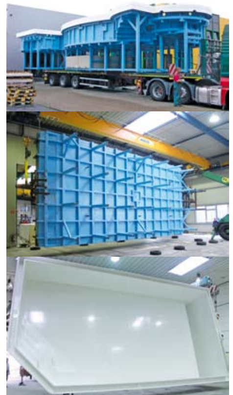
Abb. 7: Stahlkonstruktionen dreier freitragender Hart-PVC Becken im Waben-Verbundsystem
