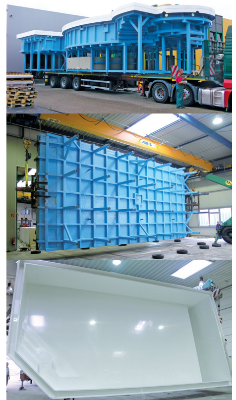
Abb. 7: Stahlkonstruktionen dreier freitragender Hart-PVC Becken im Waben-Verbundsystem
